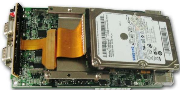
4. 要将硬盘替换为其他 IDE 硬盘, 请按照相反的步骤进行操作, 然后将 PXI-7655 控制器重新安装到 PXI 系统中。
