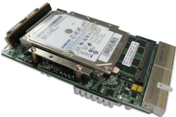
3. 向上轻轻将 IDE 硬盘拔出来。然后断开连接 IDE 硬盘软板
