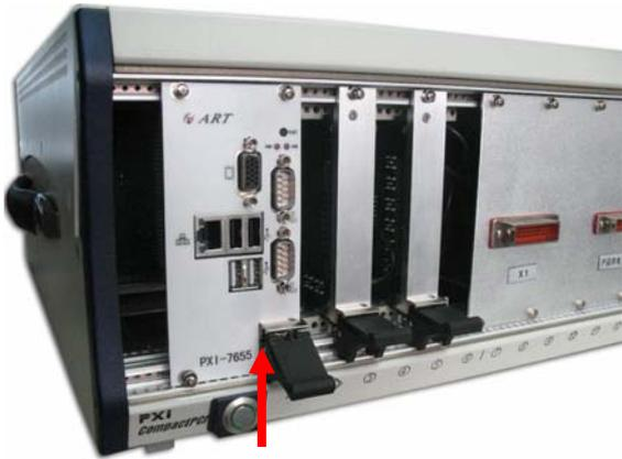
5. 上紧 PXI-7655 面板上的螺钉，然后将所有其他外设连接到 PXI-7655 控制器上。
