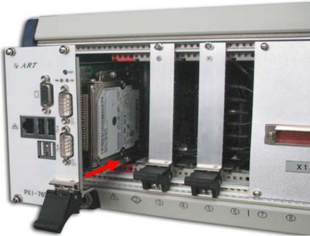
4. 抬起弹出/插入把手，直到 PXI-7655 正确连接到机箱背板为止。
