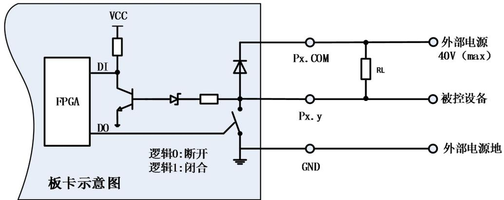
图 4-3-1 通道控制信号量输出连线示意图
