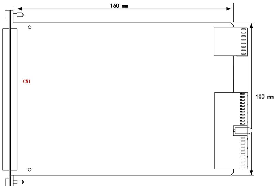
图 3-1-1 PXI2314 尺寸图
