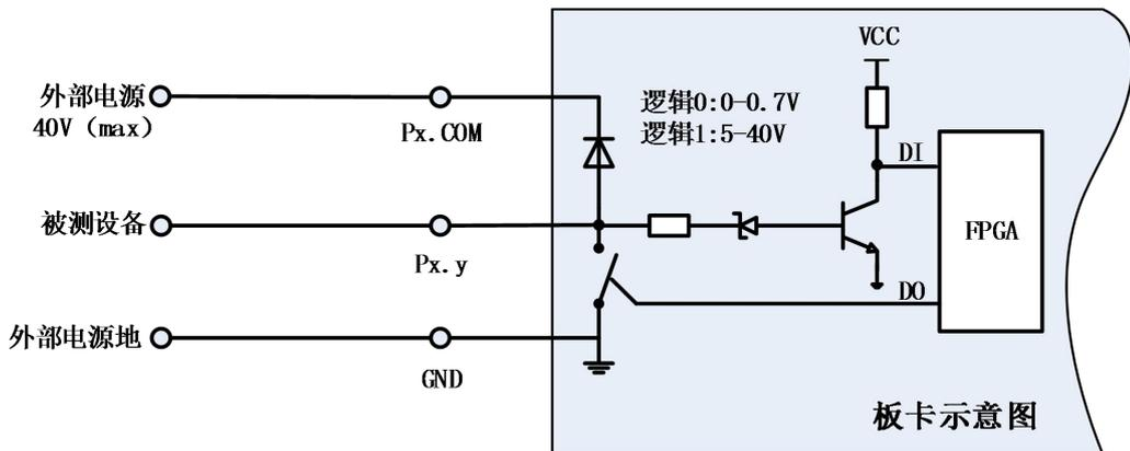
图 4-1-1 通道信号量输入连线示意图
