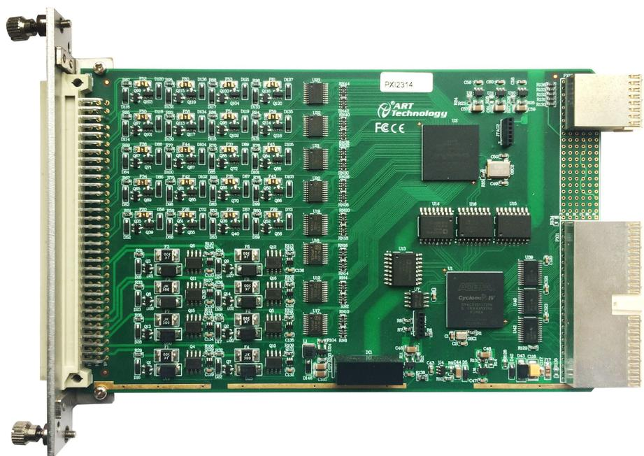
图 3-2-1 PXI2314 元件布局图
