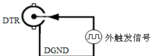
如果使用我公司配备的引线进行引号输入，那么信号源的正端接引线红色端，负向（或地）接引线黑色端。
