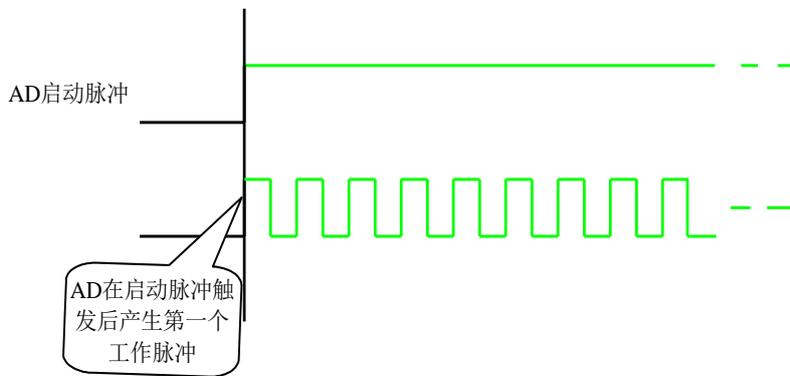
图5.1 内触发图例
