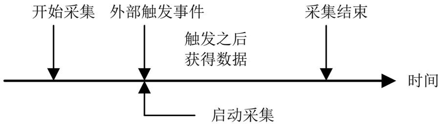
在后触发工作模式下，开始采集后，等待触发事件发生时，才启动采集。触发源为外部模拟触发或数字触发。
