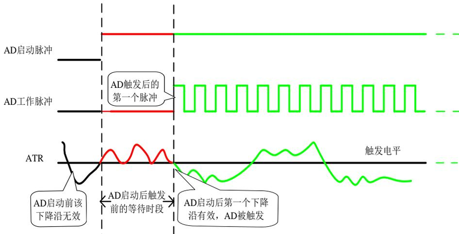
图5.3 下降沿触发图例
