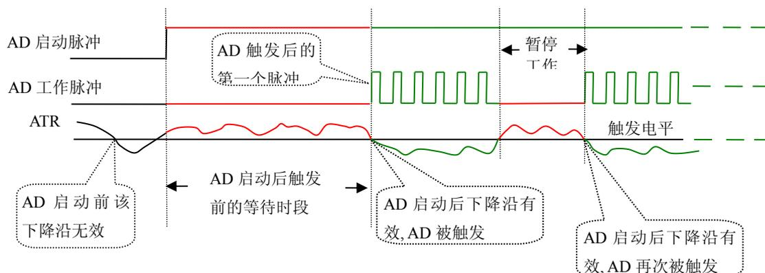
图 6.4 低电平触发
