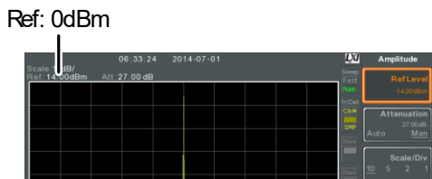
设置参考电平偏移前(offset: 0dB)
