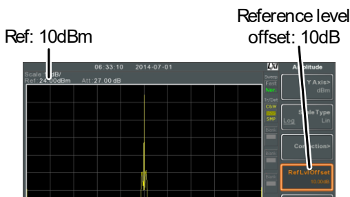
设置参考电平偏移后(offset: 10dB)
