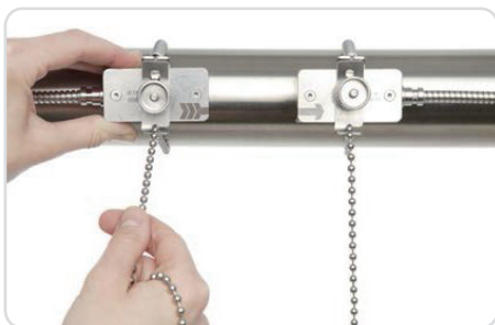
使用夹头和链条固定的换能器
