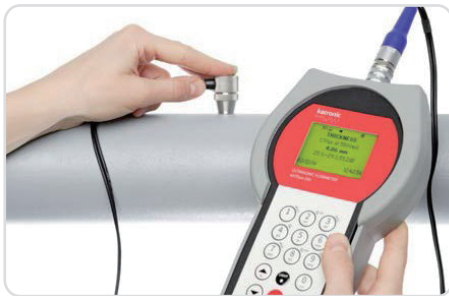
使用中的 NT 型测厚仪
