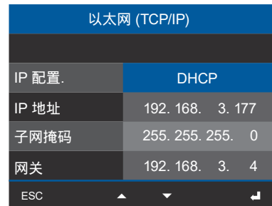
图. Ethernet (TCP/IP) 窗口
