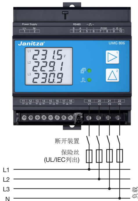
图：”电压测量“连接示例。
