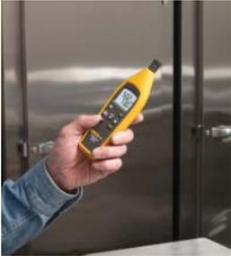
Fluke 971 温湿度计可测量-20 °C 至 60 °C (-4 °F 至 140 °F) 的温度、露点、湿球温度，以及 5 % 至 95 % 的相对湿度。
