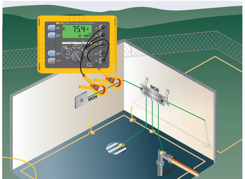
图 1：中心站的无接地辅助接地极测试。
