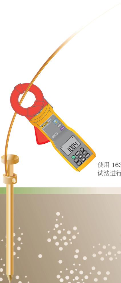
使用 1630-2 FC 为无接地辅助极测试法进行设置。
