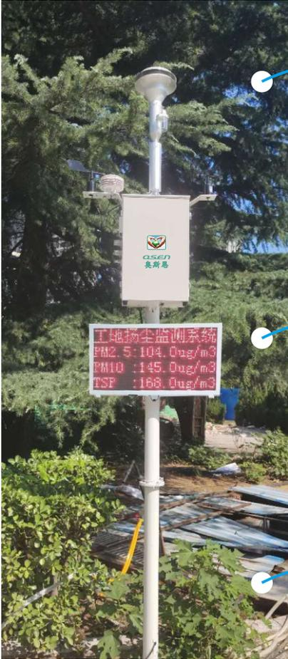
OSEN-6pro型空气质量（扬尘）在线监测系统采用β射线和光散射两种监测技术相结合的方法，对捕集到滤膜上的PM2.5和PM10颗粒浓度进行自动精确测量。
