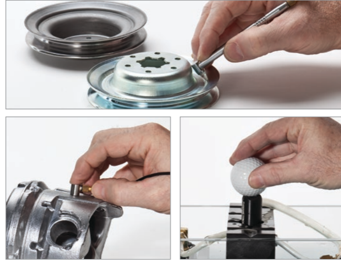
利用超声技术测得的厚度值精确、可靠，并具有可重复性。从材料一侧进行测量即可马上得到厚度读数，因此无需因切开工件而对工件造成破坏。
