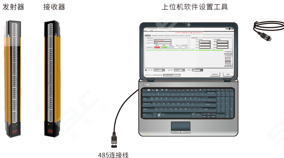
05LCMF系列测量光栅系统示意图
