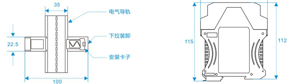
功能描述：安全继电器模块应安装在防护类型为IP54以上的电控箱内，使用DIN导轨（35mm）安装，固定在电控箱内。
