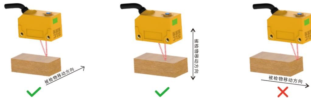
另外, 检测物体的颜色、材质有极端变化时, 如下图进行安装。
