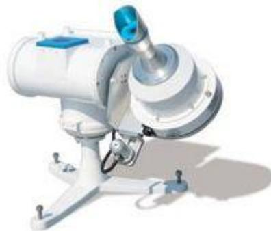
STR-32G 太阳追踪系统结合 MS-710/712 光谱辐射计，可以测量 350-1700nm 光谱范围的直接辐射。散射辐射测量/Diffuse Radiation (DHI)
