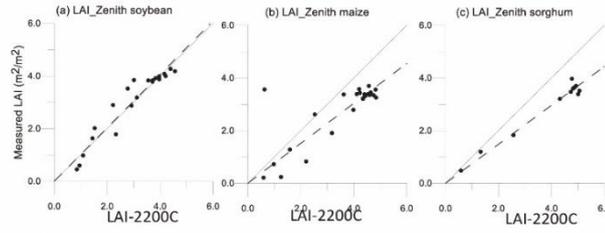
左图：黑龙江海伦农场应用三种农作物类型（大豆，玉米，高粱）的 LAISmart 测量值与 LAI-2200C 的对比
