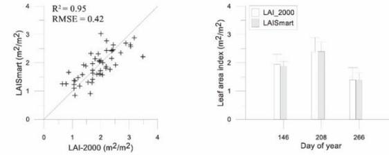
左图：河北怀来试验场应用在三个日期对玉米的 LAISmart 测量值与 LAI-2200C 的对比
