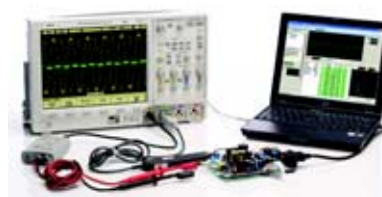
用示波器快速进行和分析电源测量
