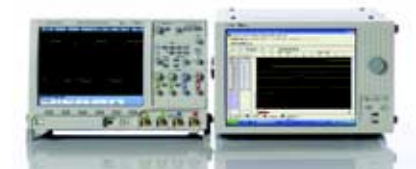
用 ViewScope 执行时间相关的示波器和逻辑分析仪测量
