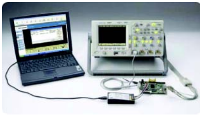
用 FPGA 动态探头和 Agilent MSO 更快和更有效地调试和验证您的 FPGA 设计
