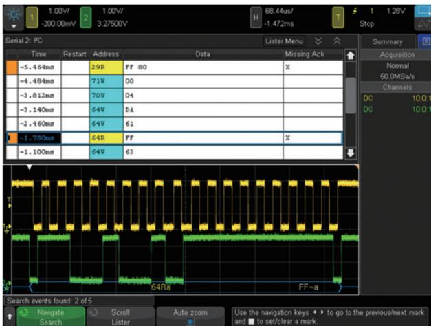
图11: 使用误码条件搜索，4000 X系列可以在I<sup>2</sup>C串行总线中快速找到5处具有丢失确认信息的结果。导航特性使您可以在误码间移动，并自动进行缩放以显示误码数据包。
