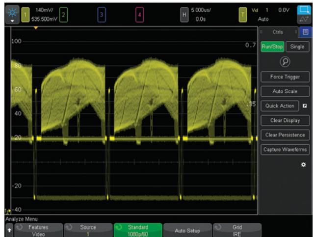
图26: 在 1080p HDTV 信号分析上进行触发。
