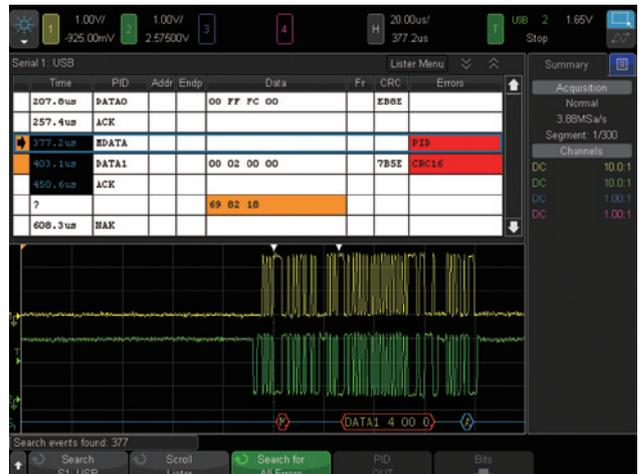
图 20: USB 2.0 触发、解码和“列表”显示。
