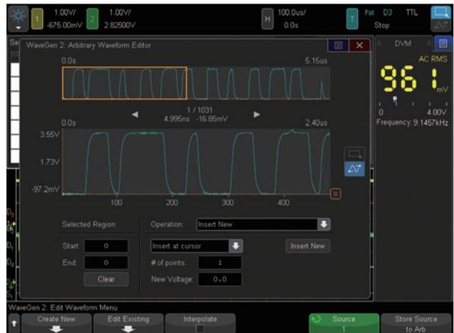
图 22: WaveGen 任意波形编辑屏幕。
