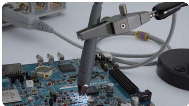
图33: 只需一个探针，并且无需更改或重新连接，N2750A InfiniiMode探头可灵活支持差分、单端和共模信号测量。
