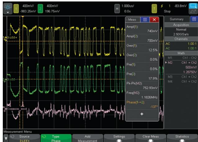
图 23: 差分任意波形信号的双通道 WaveGen 输出。共模作为运算函数显示。
