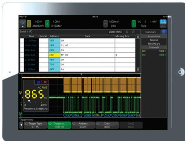
图 36: 平板电脑虚拟前面板控制控制界面。
