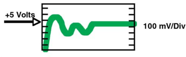
图 8. 垂直偏置改变 volt/div 参考点(从零到其它电压)
