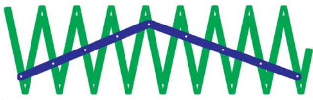
图 13. 在欠采样下的混叠波形
