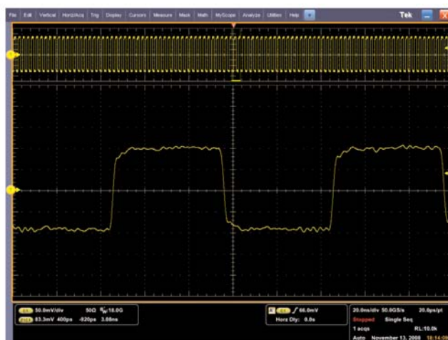
图 16. a 使用 \sin(x)/x 内插模式的过采样波形
