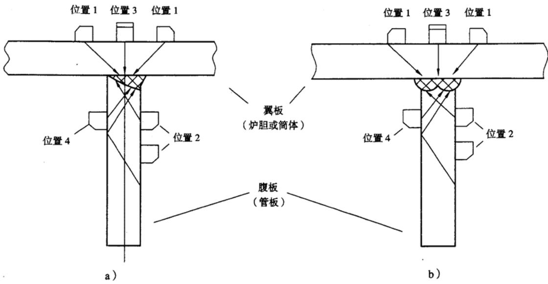
图 24 T型焊接接头 (型式 I)
