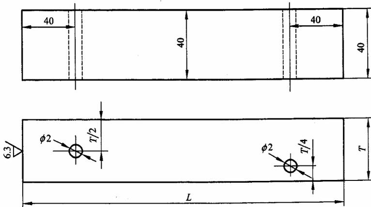
注：L—试块长度，由使用的声程确定（一般为 200mm）。
