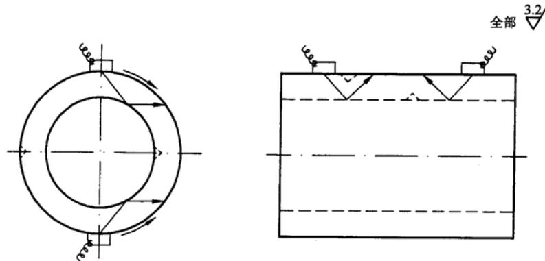
图 C.1 锻件横波检测扫查方向
