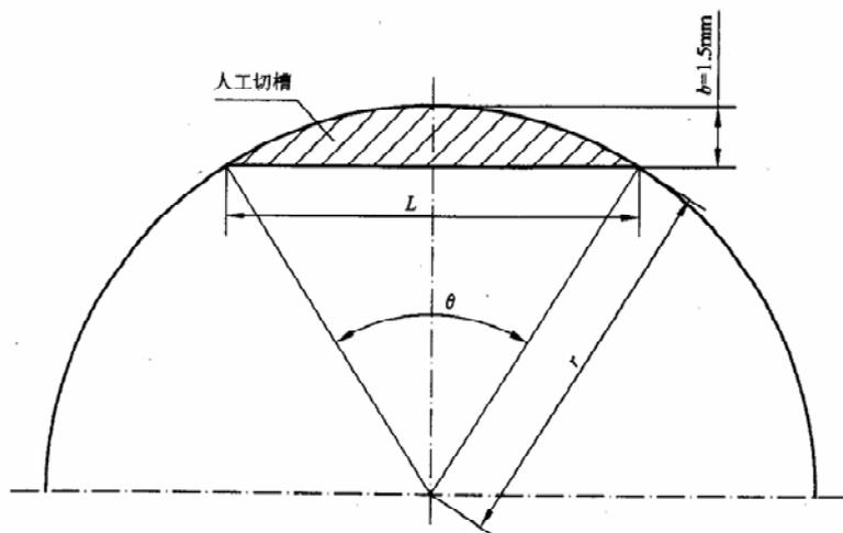
注 1:  $r$ —螺纹内半径, mm;  $L$ —人工切槽长度, mm;  $b$ —人工切槽深度, mm。
