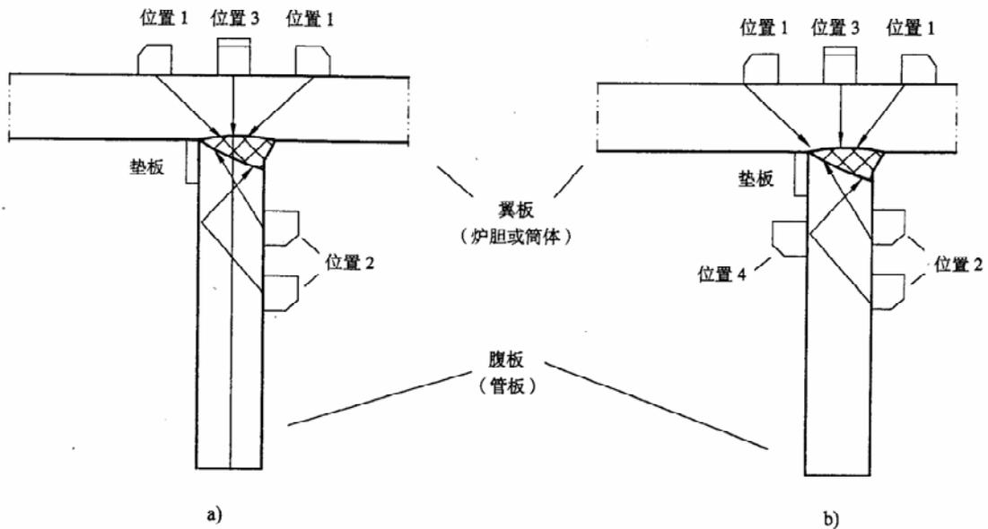
图 26 T型焊接接头 (型式 III)
