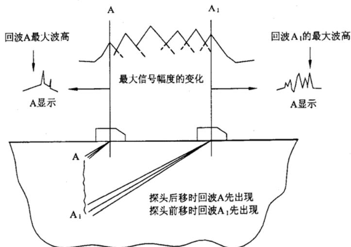
注：当端部回波达到最大时即可测出缺陷的两边 A 和 A<sub>1</sub>。
