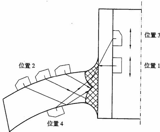
图 22 插入式管座角焊缝
