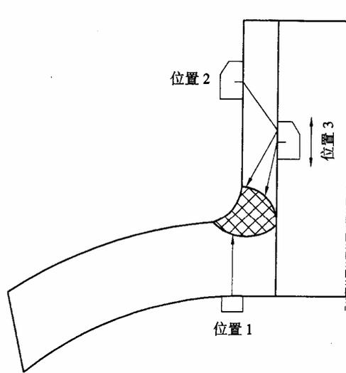
图 23 安放式管座角焊缝
