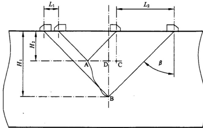
图 I.5 单斜探头对焊接接头内部倾斜缺陷测高方法
