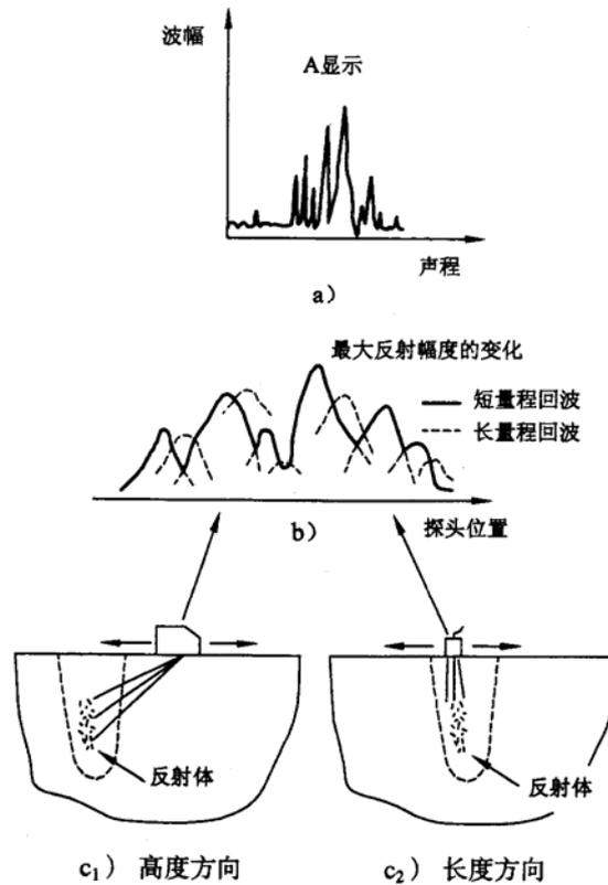
图 H.5 多重缺陷的回波动态波形
