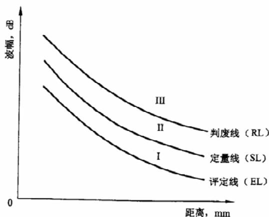
图 33 距离—波幅曲线示意图
