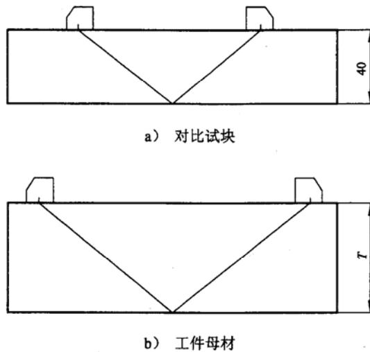
图 F.2 传输损失的测定
