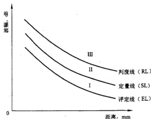
图 35 距离—波幅曲线示意图
