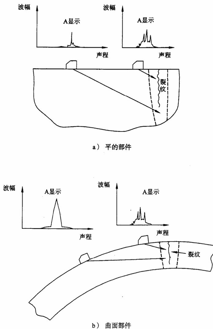
图 H.7 曲表面对平面状反射体回波动态特性的影响
