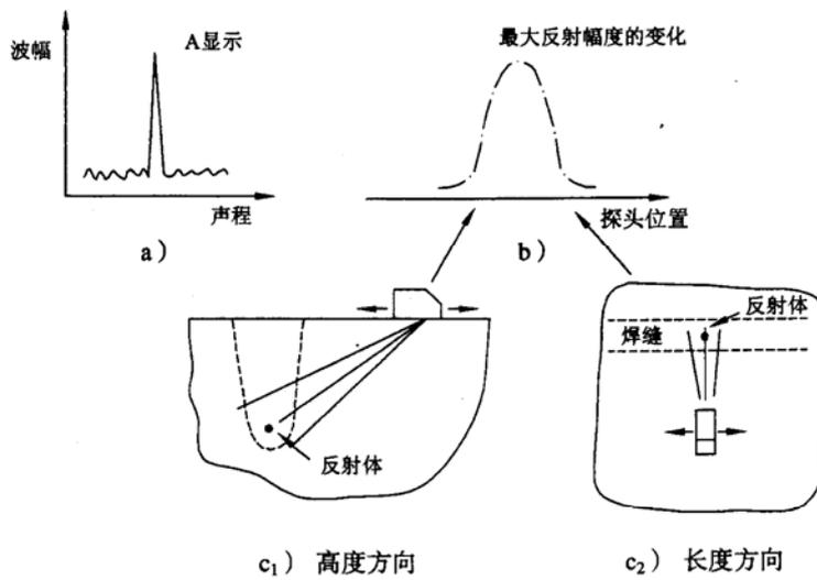
图 H.1 点反射体的回波动态波形
