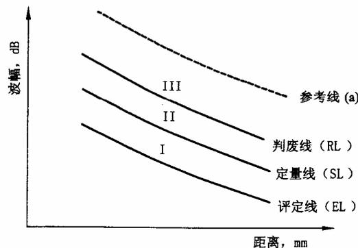
图 N.2 距离—波幅曲线示意图
