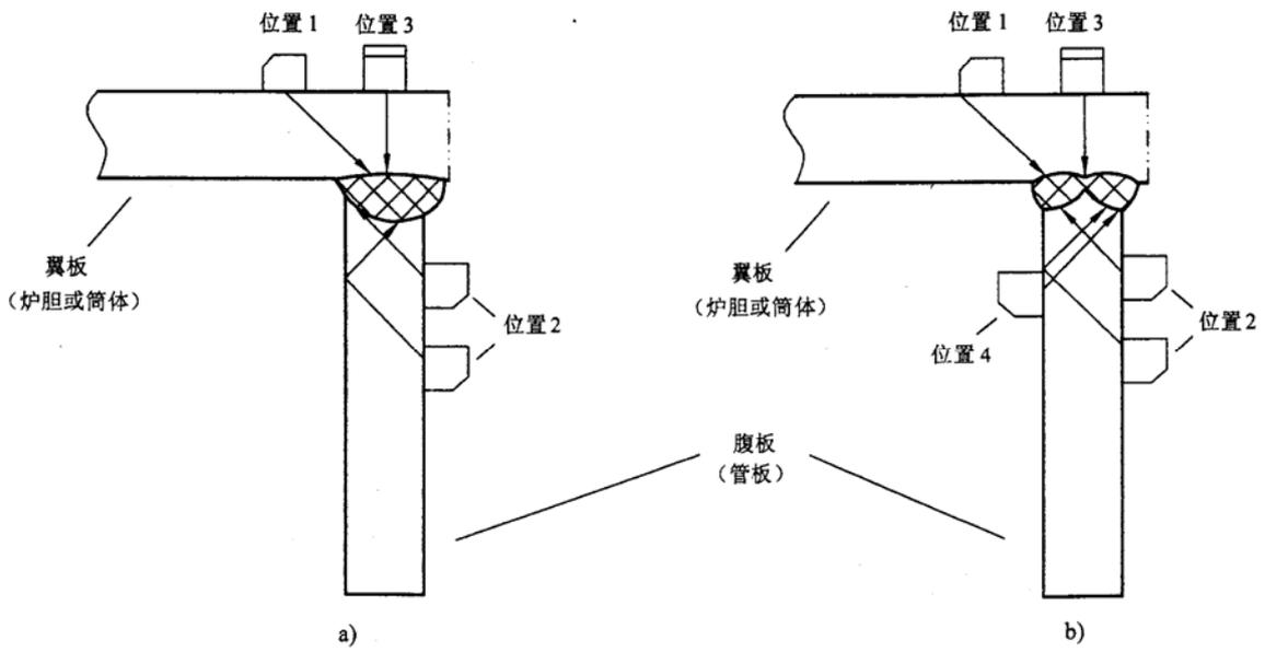
图 25 T型焊接接头 (型式 II)
