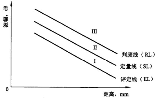
图 M.2 距离—波幅曲线
