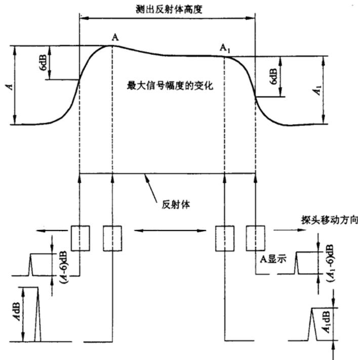
图 K.1 用 6dB 法测缺陷自身高度
