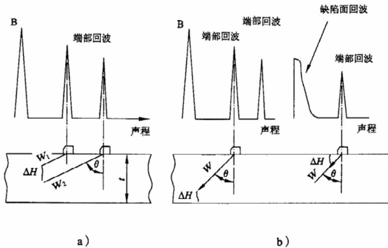
图 J.3 缺陷高度的测定方法
