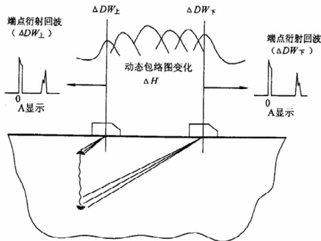
图 I.1 端点衍射回波法测缺陷自身高度
