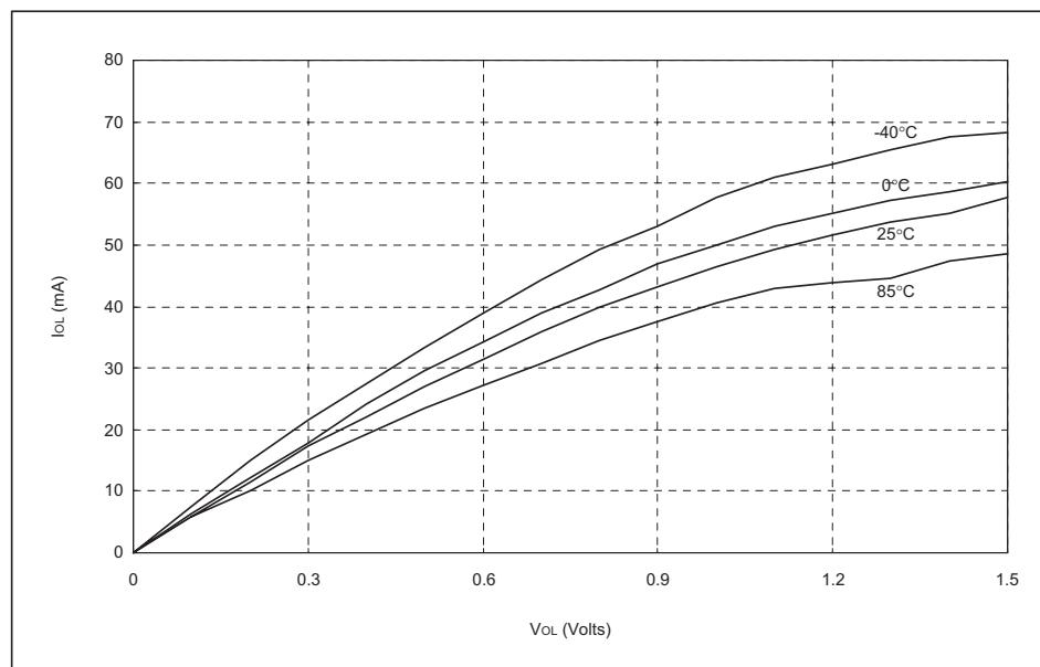
**I<sub>OL</sub> vs. V<sub>OL</sub>, V<sub>DD</sub>=5V**
