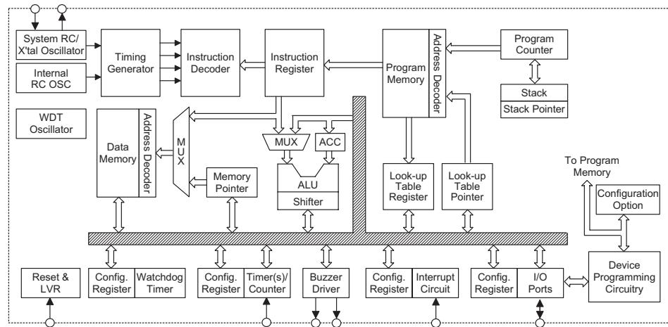
**注意：**本系统框线图为 OTP 单片机，至于 Mask 型单片机则没有 Device Programming Circuitry。
