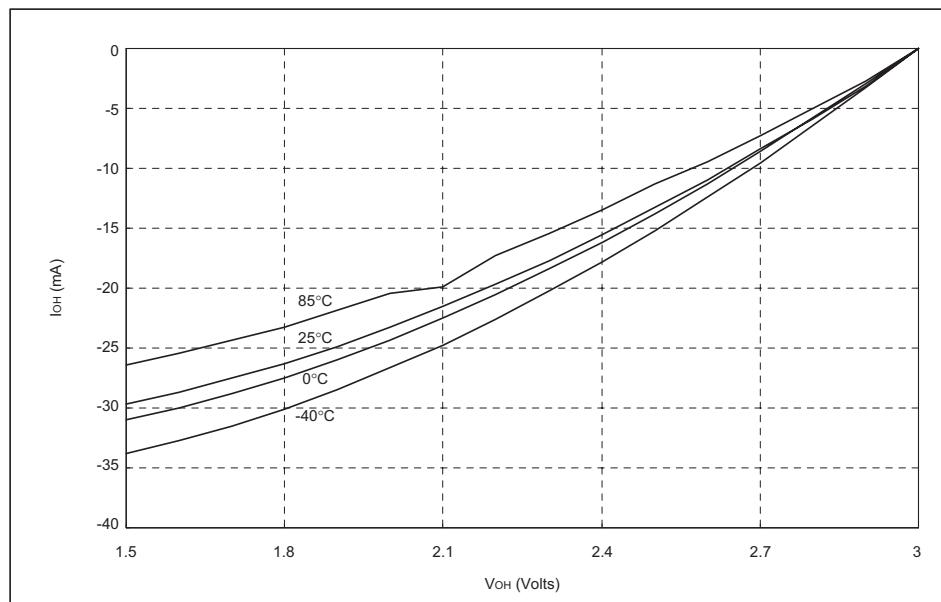
**I<sub>OH</sub> vs. V<sub>OH</sub>, V<sub>DD</sub>=5V**
