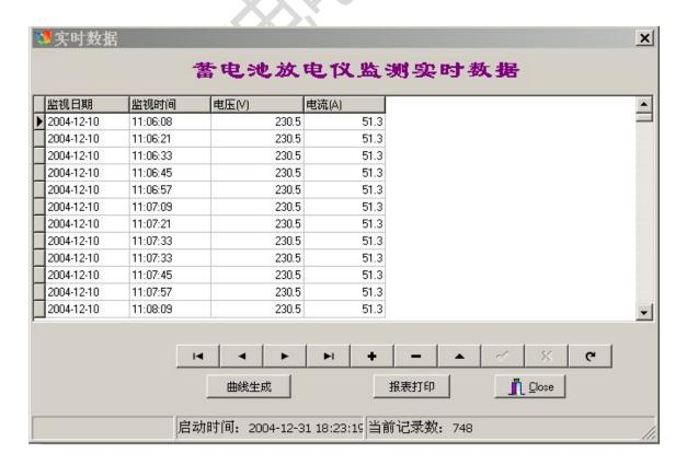
本模块数据均来自电流、电压采集系统,在此系统可以对数据表格进行处理。工具条的意义如下(从左到右)第一条,前一条,后一条,最后一条,添加,删除,编辑,更新,取消,刷新。当单击"曲线生成"按钮时显示实时曲线页面,当单击"报表打印"按钮时显示实时报表页面,可进行打印操作。
