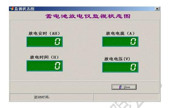
本页面数据实现放电安时的统计,由于系统采用了内部集成技术,在时间处理上采了按小时计算 方式,放电时间即为最后一次启动时间到最后一次结束时间之差。
