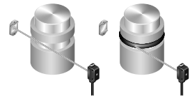
O形圈的有无检测
