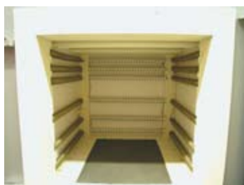
LF型窑炉的炉腔由低储热纤维材料构成，冷却时间大大缩短
