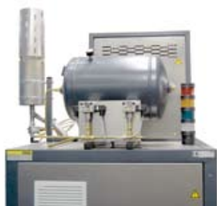
氮气紧急冲洗和排气燃烧装置（氢气操作时）
