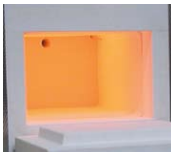
马弗炉胆四面加热
