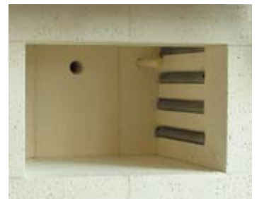
炉腔具备高级轻质耐火砖保温结构
