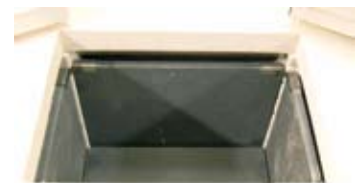
S 73/HS的炉膛衬装SIC板
