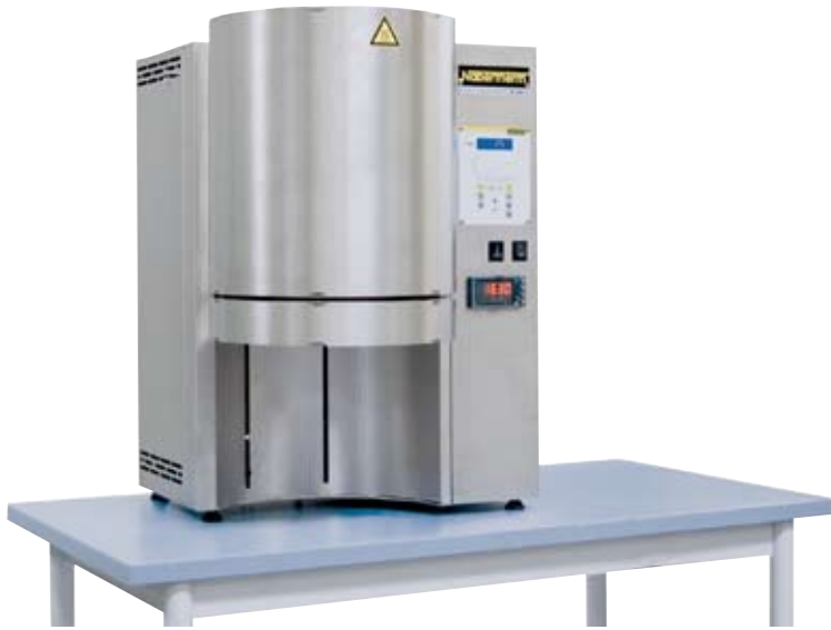
LHT 02/17 LB 关闭，带有过温保护限制器
