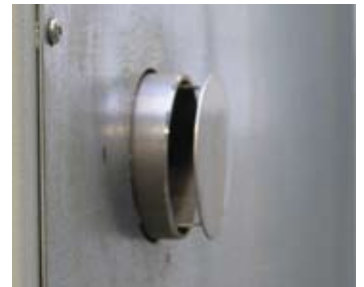
炉后壁设有排气管，用于排除干燥时产生的废气
