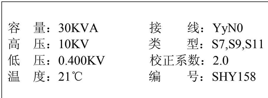
图中可见第一行为提示行，提示行提示‘上下键移动选项，左右键改变当前选项’如图所示，此时上下按键可将光标指向其他选项，共六行代表六种参数，包括：变压器容量、高额定电压、低额定电压、接线方式、变压器类型、当前温度，光标指向哪一项，可对哪项进行改变，图九中选中项为变压器容量，按左右键能改变当前变压器容量数值。图十中选中项为当前温度；按左右键可改变当前温度的数值，
