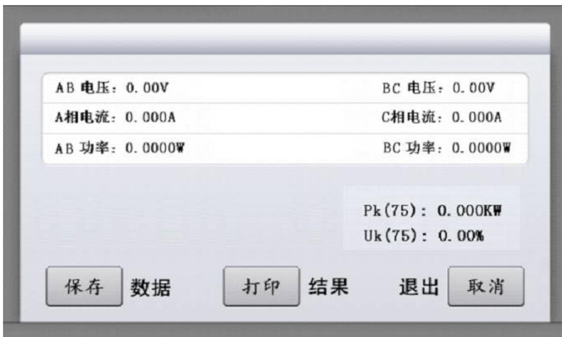
图十一 两元件法负载测试
