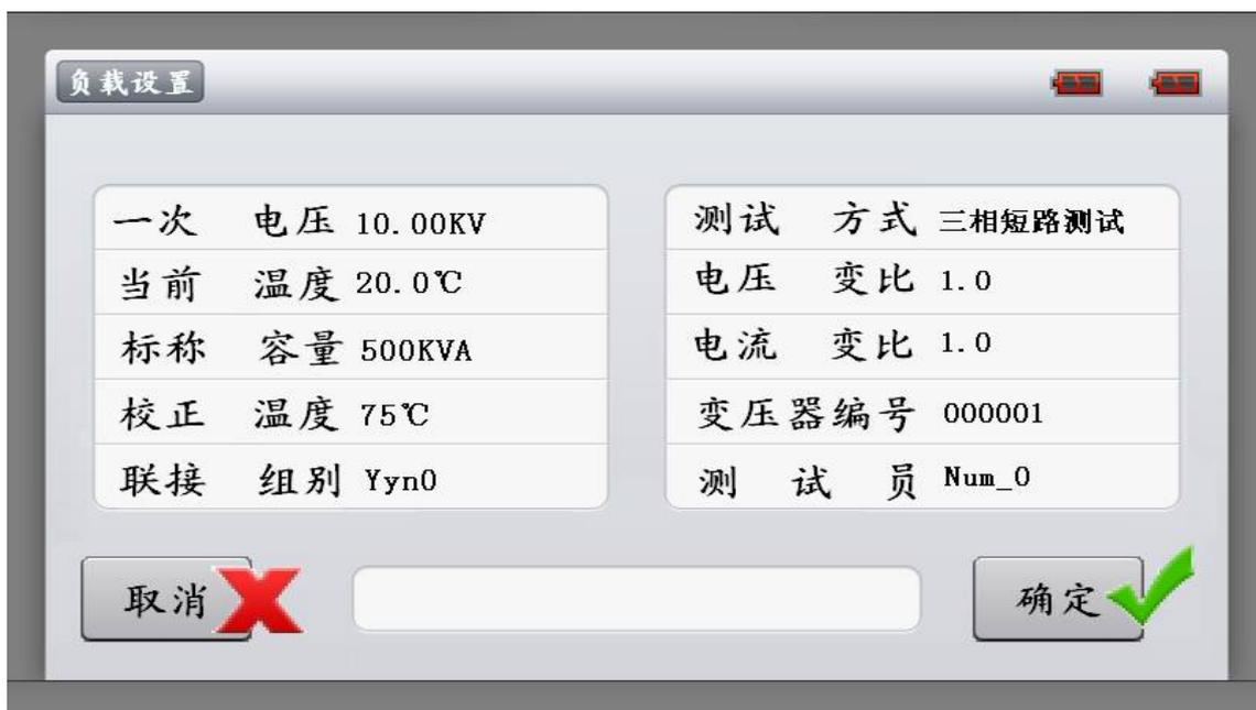
图九 负载测试参数设置界面
