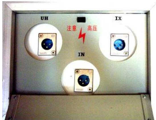
图（二） 仪器测试接线插孔示意图
