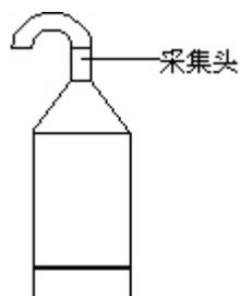
(1) 更换电池时，逆时针旋转，将采集器外壳取下。再将电池盖打开，更换电池。(电池所需型号 AG13 、数量 5 个)
