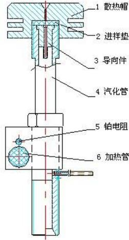
图 1.7 LYGC-6800 电力气相色谱仪进样器结构示意图
