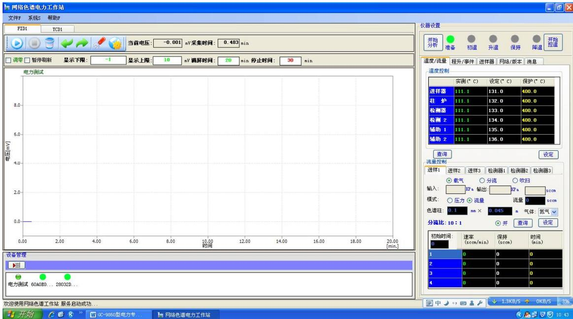
界面的上方是下拉式菜单；下拉式菜单下方是检测器的运行参数和屏幕显示参数；中部是谱图数据显示区；最下方是色谱仪状态指示区；右面是色谱仪的运行参数。左下角显示了通信服务连接状态是否成功。
