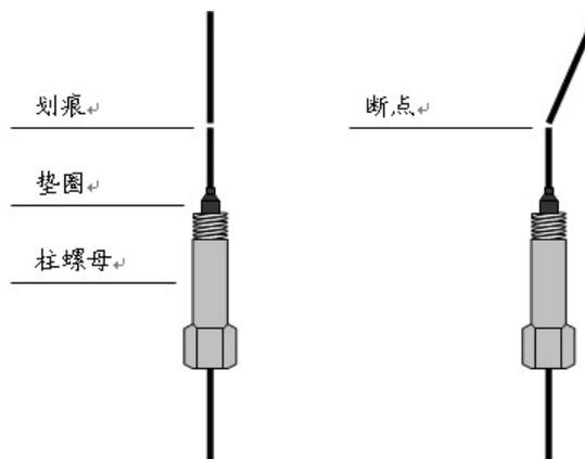
图 6.2 :准备熔融硅毛细管柱
