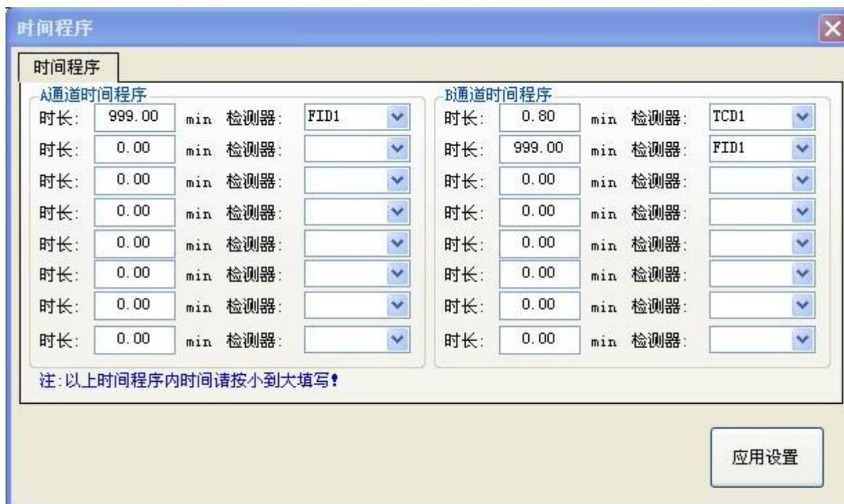
上面设置的含义是：FID1 检测器的数据在开始采样至 999 分钟内送给电力工作站处理软件的 A 通道；TCD1 检测器的数据在开始采样至 0.8 分钟内送给电力工作站处理软件的 B 通道, 0.8 分钟至 999 分钟是由 FID1 检测器的数据送给电力工作站处理软件的 B 通道。
