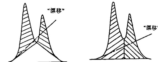
图4 “漂移”设定引起的面积求法的差异
