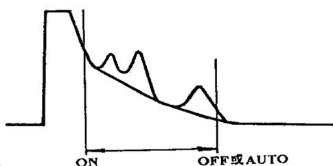
注意: ON 设在主峰的下坡处, 即在主峰的顶点之后与第一个尾上峰的起点之前的时间段内。
