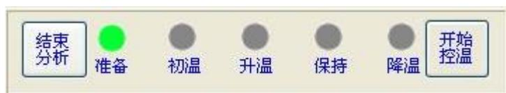
单击**开始控温**即启动这台色谱仪开始控温及 EFC 模块的工作，同时图标会自动变成**结束控温**。单击**结束控温**即关闭这台色谱仪的控温，同时图标会自动变成**开始控温**。
