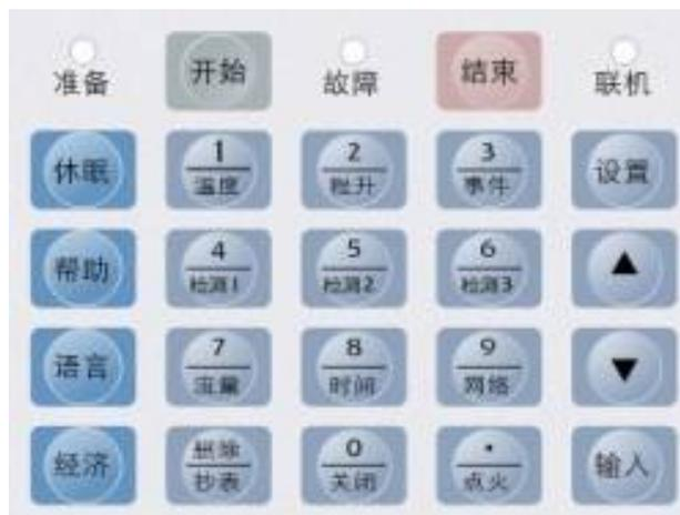
LYGC-6800 电力气相色谱仪的操作键盘共 22 个操作按键以及 3 个状态指示灯：
