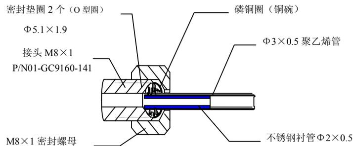
图 2.2 聚乙烯管气路连接示意图
