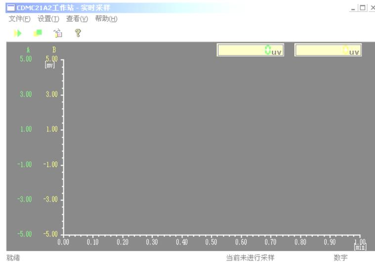
标样采样时间到，系统自动关闭采样画面回到主画面，系统会询问是否重新计算校正因子，如果已经存在旧的ID表且不需要重新编辑，按“是”钮，系统会自动根据当前的标样分析结果重算校正因子。不重新编辑ID表，则直接做第（6）步。如果需要重新编辑ID表，参见下一步
