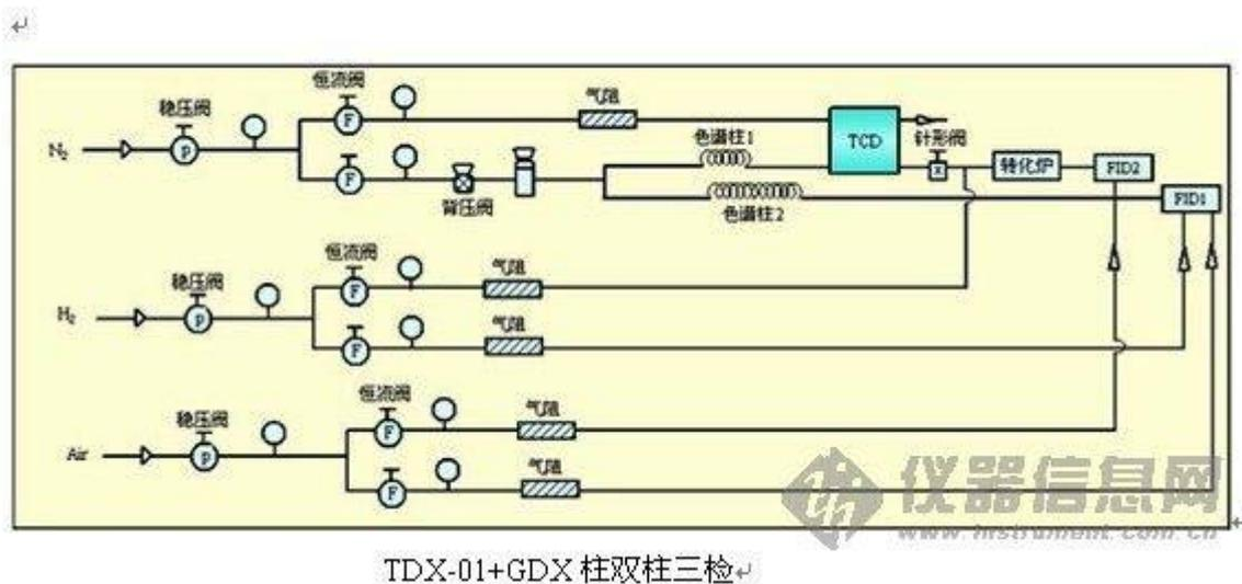
图 1.1 电力气相色谱仪气路图
