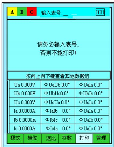
**打印操作说明：**仪器适配 VMP01 微型打印机，使用时将仪器专配打印线的一端六芯插头接入主机 P 端口，另一端六芯插头接入打印机，按打印机 POWER 键约 3 秒钟，打印机指示灯亮，此时即可打印。本打印机为镍氢充电电池供电，充电方法详见打印机使用说明书。
