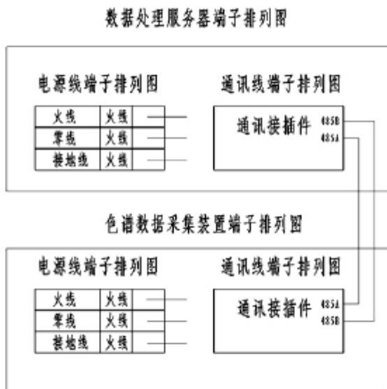
图 4.1 色谱数据采集装置、数据服务器端子排列图
