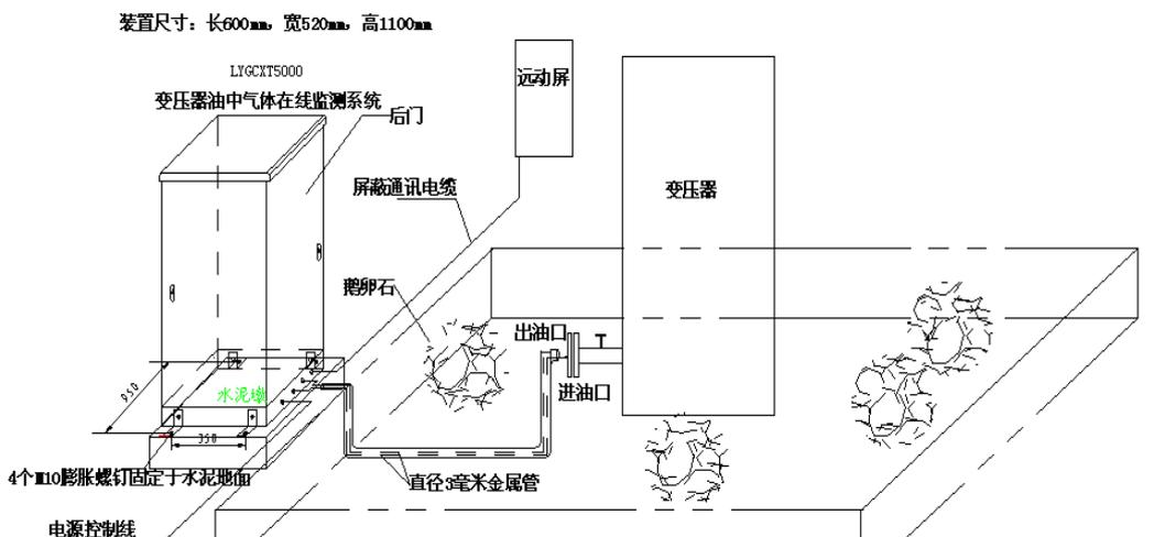
图 3.2 基础平台示意图
