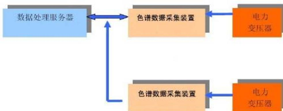
图 3.4 系统监测电力变压器一对多连接图
