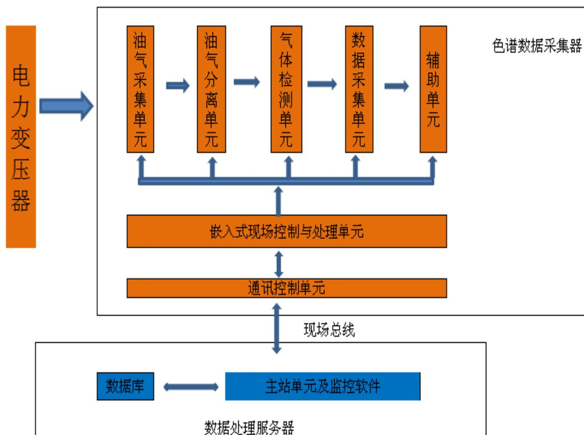
图 2.1 LYGCXT5000 变压器油色谱在线监测系统组成示意图
