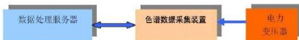
图 3.3 系统监测电力变压器一对一连接图
