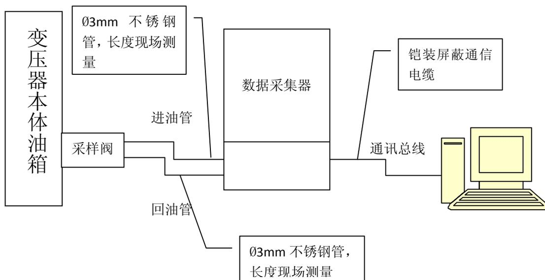
图 3.1 LYGCXT5000 油路系统连接图
