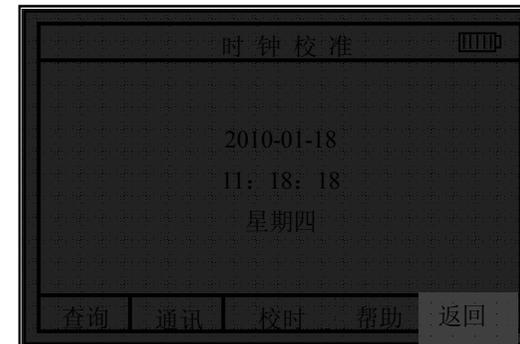
注: 按功能键“校时”, 进入校时界面, 用方向键移动光标, 选择数字键进行时间校准;
