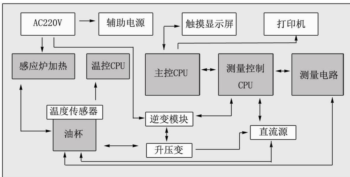
图三 仪器内部功能构造框图
