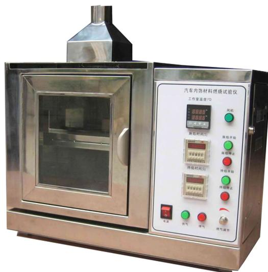
汽车内饰材料燃烧试验主要是根据国标 GB8410-2006及美标 FMVSS 571.302等标准规定的模拟燃烧性能安全试验项目。
