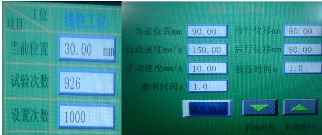
按要求预置设置次数，通过手动正反转观察推杆按压试样位置，将“当前位置”数值设置为前行位移，将机械手退回的适当距离设置为后行位移。手动速度可适当设置。按压时间、前后行位移及速度设置应符合标准要求的频率要求。
