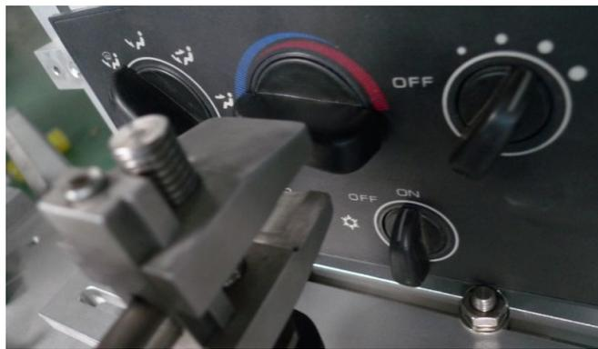
首先，在开关起点将夹持头夹紧开关，初始化及清零当前位置，确定起始夹持位置。然后松开，后退开关夹具，转动开关一个档位，再手动正转（如逆时针反转，面对开关方向）夹持头，至刚刚好能夹持开关当前档位，读数当前角度即此档位需旋转角度。第二、第三档位可依次类推。
