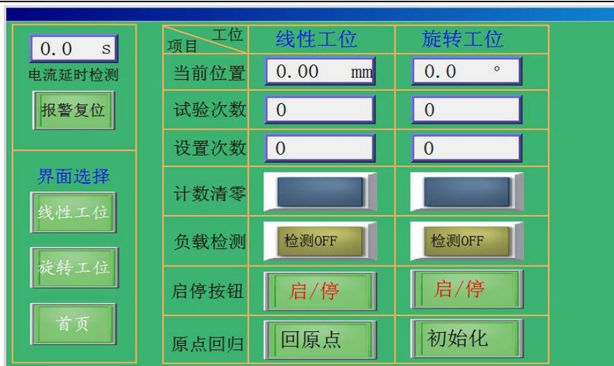
**电流延时检测：**检测到导通信号到发出判断时间，接通时间应大于检测时间，可预置
