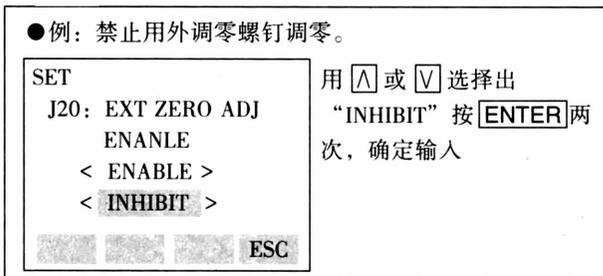
· 用变送器的外调零螺钉调零时, 用一字螺丝刀, 旋转变送器外壳盒上的调零螺钉, 顺时针调节输出增加, 逆时针调节输出减少, 零点调整按量程的 0.01% 的步幅进行调整。
