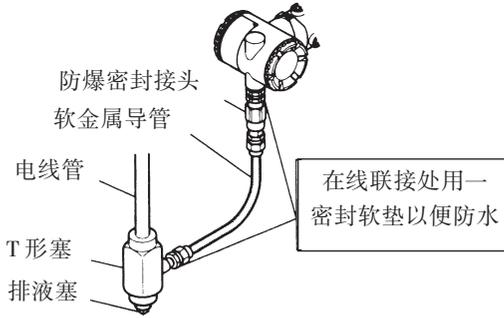
图 6.4.2b 配线用隔爆密封接头
