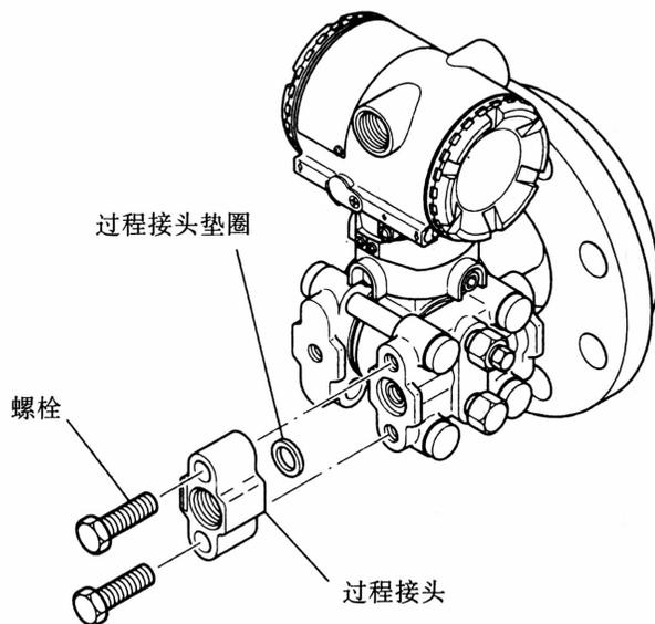
图 9.4.2 过程接头垫圈的更换
