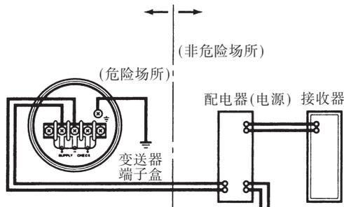
图 6.4.1a 变送器与配电器的连接
