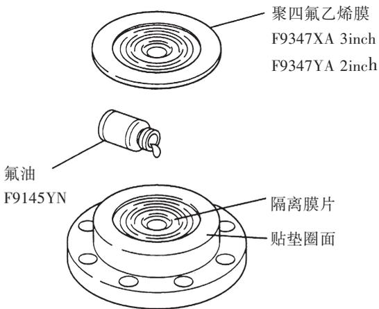
图 4.3 聚四氟烯膜片的安装
