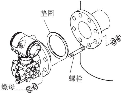
图 4.1 变送器的安装
