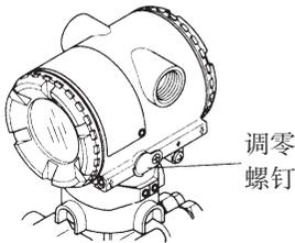
在进行液位变送器的零点调整时，有可能液罐内液位调不到测量范围的下限值(0%)。这时，可将变送器的输出信号调至(例如玻璃柱读数)实测值的一致。
