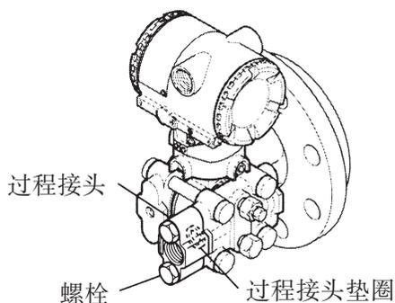
图 2.1 变送器安装用零部件
