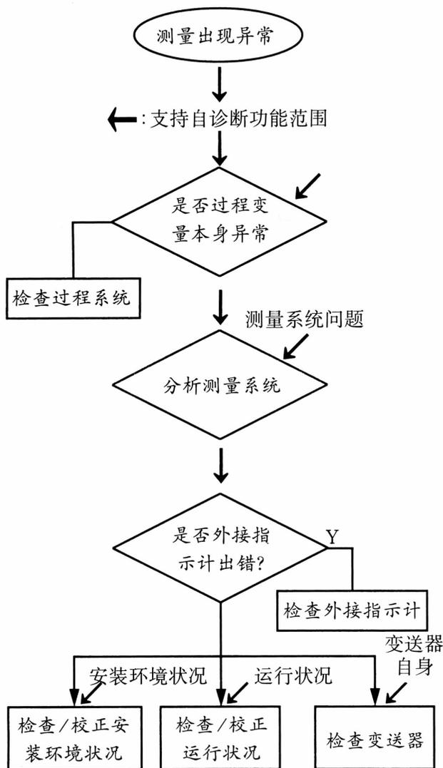
图 9.5.1 基本流程及自诊断
