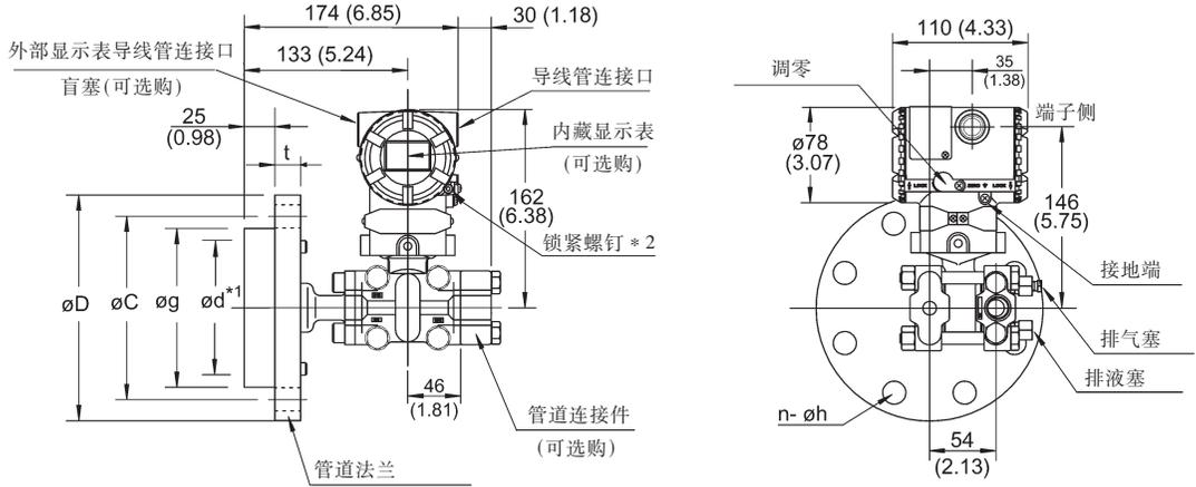
\* 1 表示垫圈接触面的内径
