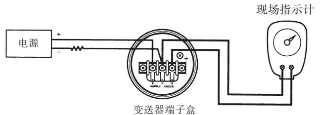
图 6.3.2 外接指示计连接
