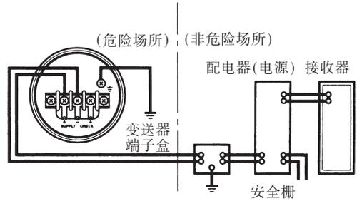
图 6.4.1b 变送器与配电器的连接
