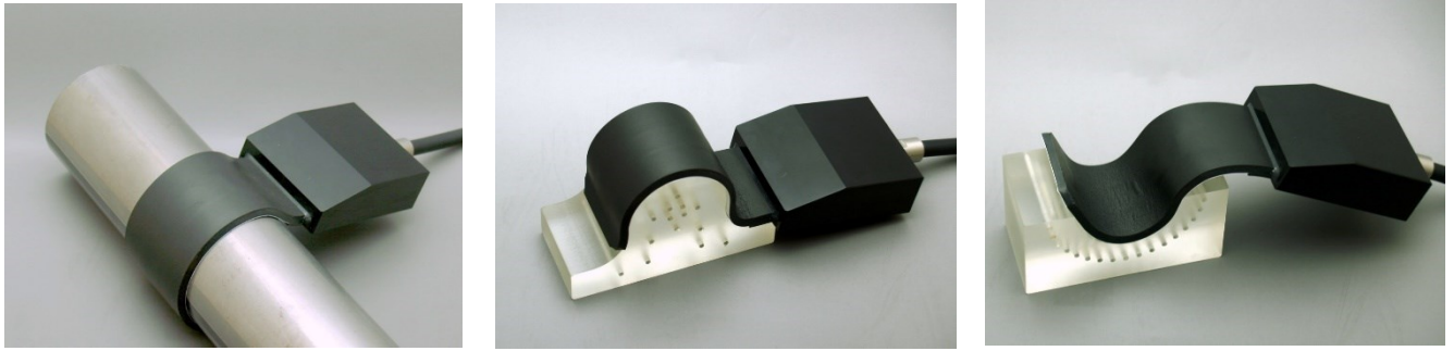
图1 宽频柔性相控阵探头的各种形状 (BFAP)
