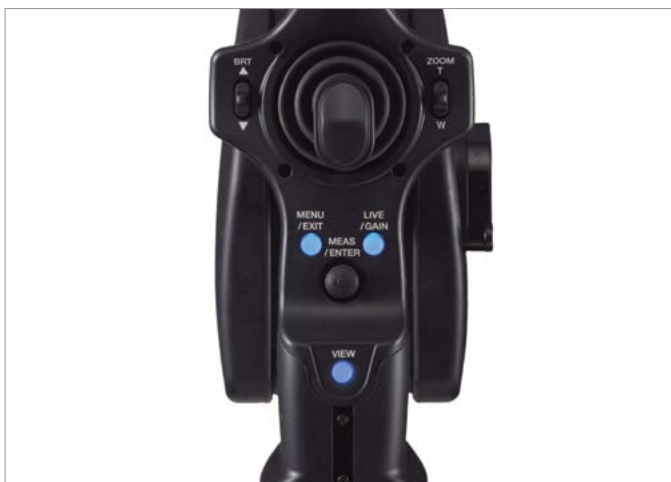
手持式控制器拥有超过14种单触摸功能的快速访问按钮
