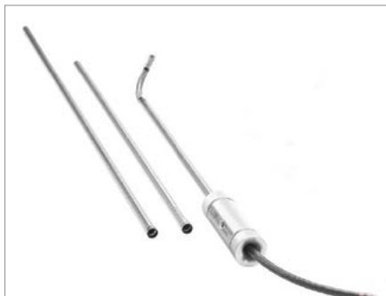
硬套管组 MAJ-1253 (用于6.0mm插入管) MAJ-1737 (用于4.0mm插入管) 硬套管组适用于6.0mm和4.0mm的插入管。 每组包含三个硬套管，长度分别为250mm、340mm和450mm。
