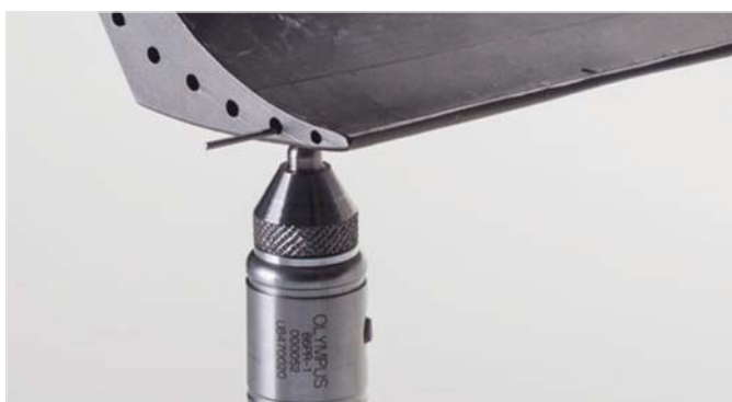
使用目标钢线对涡轮叶片进行测量
