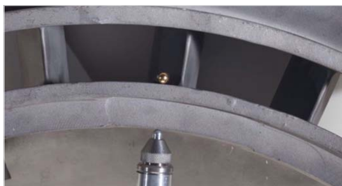
对24.1毫米的航天器铸件进行测量
