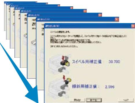
使用 3 轴调整工作台时的 FORMTRACEPAK 导向画面
