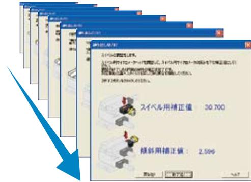
使用3轴调整工作台时的FORMTRACEPAK导向画面
