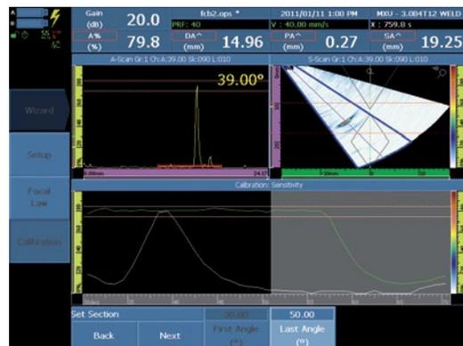
在扇形扫查中，对所定义的扇区进行灵敏度校准。
