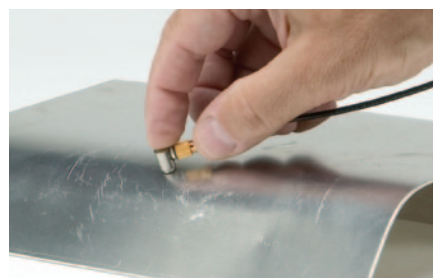
可测量金属材料因弯曲而变薄的临界厚度值。
