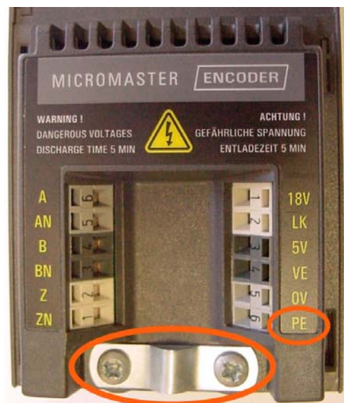
图 15-4 屏蔽接线端和 PE 端子
