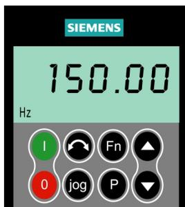
利用基本操作面板（BOP）可以更改变频器的各个参数。为了用 BOP 设置参数，您首先必须将 SDP 从变频上拆卸下来，然后装上 BOP（参看附录 A）。
