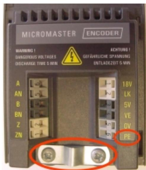
图 15-4 屏蔽接线端和 PE 端子
