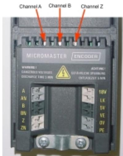
图 15-5 编码器模板上的 LED 指示灯
