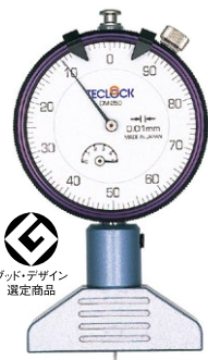
DM-250 ベース長さ50mmの 小形タイプ 目量0.01mm 測定範囲5mm
