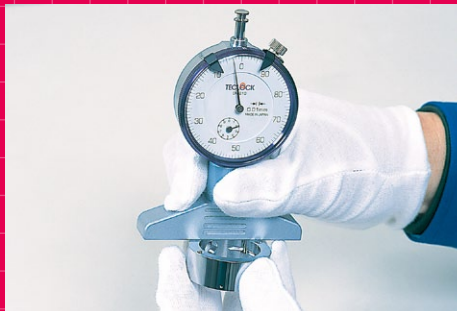
中央部がくり抜かれたワーク凹部の深さを測定しています。写真は2.03mmを示しています。
