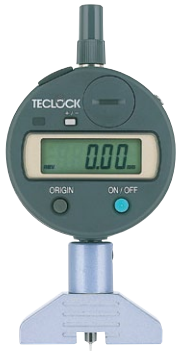
DMD-252S プリント基板測定用 凹凸両面の測定ができます 最小表示量0.01mm 測定範囲凹5mm凸4mm
