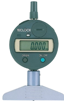
DMD-2110S φ2mmニードル測定子タイプ 最小表示量0.001mm 測定範囲10mm
