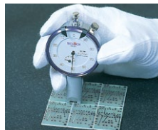
DM-251を用いた プリント基板の溝の深さ測定
