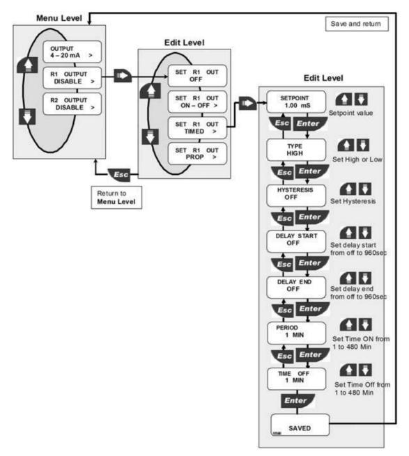
在显示 SET R1 OUT TIMED 时,按右键进入编辑层级,显示 SETPOINT,设置控制点,通过上下键选择要控制的 pH/ORP 值,按 EMTER 键确认后,显示 TYPE,通过上下键选择控制类型为高 (HIGH) 或低(LOW),按 ENTER 键确认后,显示 HYSTERESIS,通过上下键选择缓冲时间,选择 OFF 时,继电器会即时反应。按 ENTER 键确认后,显示 DELAY START,通过上下键设置延迟开始时间,范围可以达 960 秒,选择 OFF 时继电器动作不延迟。按 ENTER 键确认后,显示 DELAY END,通过上下键选择延迟结束时间,范围可以达 960 秒。按 ENTER 键确认后,显示 PERIOD,通过上下键选择继电器动作 ON 的周期,选择范围从 1 到 480 分钟。按 ENTER 键确认后,显示 PERIOD OFF,通过上下键选择继电器不动作 OFF 的周期,按 ENTER 键确认后就返回了输出菜单层级。
