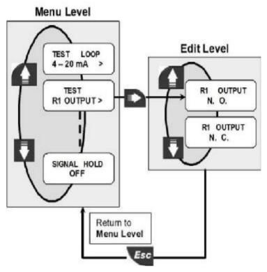
按上/下键改变R1的工作方式(NO和NC)。(测试R1(OUT1)后会到测试R2(OUT2))
