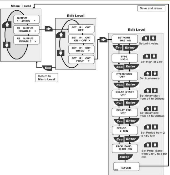
如果控制类型选择为高,当测量 pH/ORP 值高于设定点时,继电器将开始输出比例信号,仪表屏幕显示 OUT1 下面的 LED 指示灯发亮。当测量 pH/ORP 值低于设定点与缓冲值之差时,继电器停止动作。
