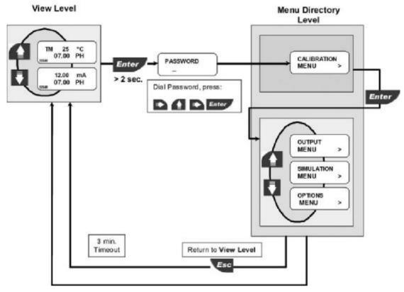
在查看层级时,按 ENTER 键键 2 秒并按照右、上、右和 ENTER 键次序输入密码进入第一个菜单目录层级,在这个层级按 ENTER 键进入第二个菜单目录层级。
