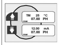
自动补偿状态下的温度显示或手动补偿状态下的温度设定值和 pH 显示值
