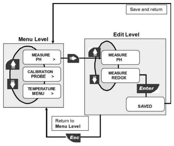
P6.02,在连接PH电极测量pH,连接ORP电极时测量ORP(氧化还原电位)。在屏幕显示 MEASURE PH或MEASURE REDOX时,按右键,然后通过上下键可以选择所连接的电极 类型,按ENTER键完成确认。
