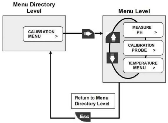
第一个菜单目录层级中按右键进入校准菜单。可以完成选择电极(pH或ORP)、电极校准、温度设置工作,通过上下键可以进入对应的功能。
