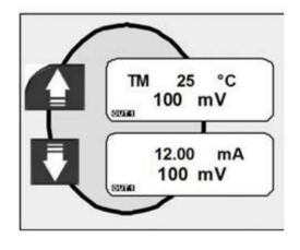
自动补偿状态下的温度显示或手动补偿状态下的温度设定值和 ORP 显示值
