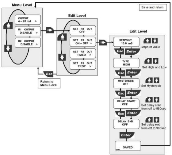
在显示 SET R1 OUT ON-OFF 时,按右键进入编辑层级,显示 SETPOINT,设置控制点,通过上下键选择要控制的 pH/ORP 值,按 ENTER 键确认后,显示 TYPE,通过上下键选择控制类型为高(HIGH)或低(LOW),按 ENTER 键确认后,显示 HYSTERESIS,通过上下键选择缓冲值。按 ENTER 键确认后,显示 DELAY START,通过上下键设置延迟开始时间,范围可以达 960 秒,选择 OFF 时继电器动作不延迟。按 ENTER 键确认后,显示 DELAY END,通过上下键选择延迟结束时间,范围可以达 960 秒。按 ENTER 键确认后,就返回了输出菜单层级。
