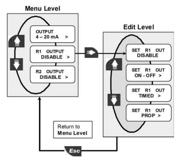
在输出信号设置(OUTPUT MENU)的菜单目录中,通过上下键选择 R10UTPUT,按右键进入继电器 R1 编辑层级,通过上下键可以选择关闭(DISABLE)、开关 (ON/OFF)、时间(TIMED)和脉冲(PROP)的工作模式。
