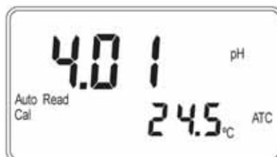
3. 將電極清洗乾淨，放入第二個標準液中，按 **[ENTER]** 鍵開始第二點校正，畫面中 Auto Read 和 Cal 閃爍。
