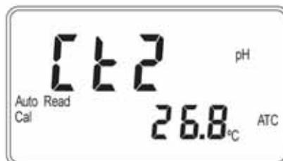
4. Auto Read 和 Cal 停止閃爍，儀器顯示第二點校正之 pH 值，五秒後自動進入第三點校正時，按 **[MODE]** 鍵。
