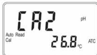
4. 將電極清洗乾淨，放入第二個標準液中，按 **ENTER** 鍵出現量測值，按上下鍵修改為自定 Buffer 值，按 **ENTER** 鍵開始讀取訊號，畫面中 Auto Read 和 Cal 閃爍。
