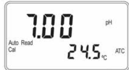
5. 將電極清洗乾淨，放入第三個標準液中，按 **ENTER** 鍵開始第三點校正，畫面中 Auto Read 和 Cal 閃爍。
