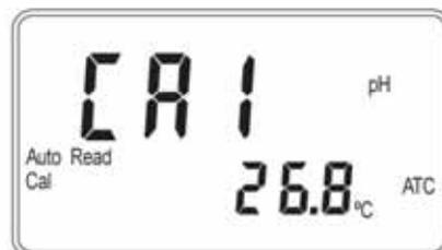
2. 將電極清洗乾淨，放入第一個標準液中，按 **ENTER** 鍵出現量測值，按上下鍵修改為自定 Buffer 值，按 **ENTER** 鍵開始讀取訊號，畫面中 Auto Read 和 Cal 閃爍。
