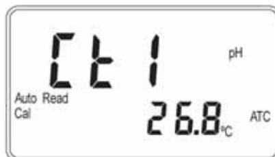
2. Auto Read 和 Cal 停止閃爍，儀器顯示第一點校正之 pH 值，五秒後自動進入第二點校正。
