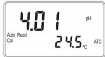
3. 將電極清洗乾淨，放入第二個標準液中，按 **ENTER** 鍵開始第二點校正，畫面中 Auto Read 和 Cal 閃爍。
