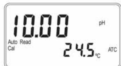
6. Auto Read 和 Cal 停止閃爍，儀器顯示第三點校正之 pH 值，五秒後自動進入下一畫面。
