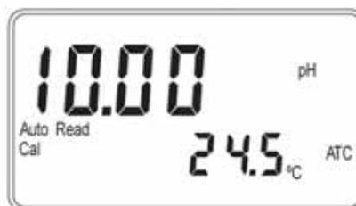
7. 螢幕將自動顯示校正之Offset 1 值，按 **ENTER** 鍵顯示校正之Slope 1 值，續按 **ENTER** 鍵顯示校正之Offset 2 值，續按 **ENTER** 鍵顯示校正之Slope 2 值，續按 **ENTER** 鍵即回到測量模式。
