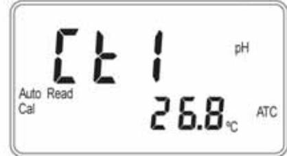
2. Auto Read 和 Cal 停止閃爍，儀器顯示第一點校正之 pH 值，五秒後自動進入第二點校正。
