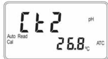
4. Auto Read 和 Cal 停止閃爍，儀器顯示第二點校正之 pH 值，五秒後自動進入第三點校正。
