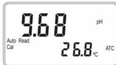
5. Auto Read 和 Cal 停止閃爍，螢幕將自動顯示校正之 Offset 1 值，按 **ENTER** 鍵顯示校正之 Slope 1 值，續按 **ENTER** 鍵即回到測量模式。
