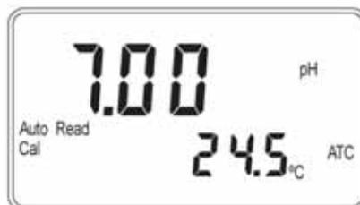
5. 出現 Offset 1 值，按 **[ENTER]** 鍵顯示校正之 Slope 1 值，續按 **[ENTER]** 鍵即回到測量模式。
