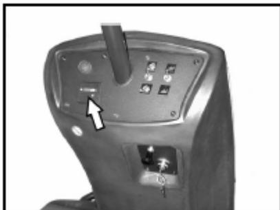
时间计时器可用于指示维护时间间隔。
