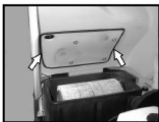
在设备外盖上的凹槽内，将过滤器箱的密封条取出，并更换上新的。
