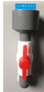
速度較慢，請緩慢耐心加入。直至壓力桶低水位指示燈熄滅，說明壓力桶水位已加
